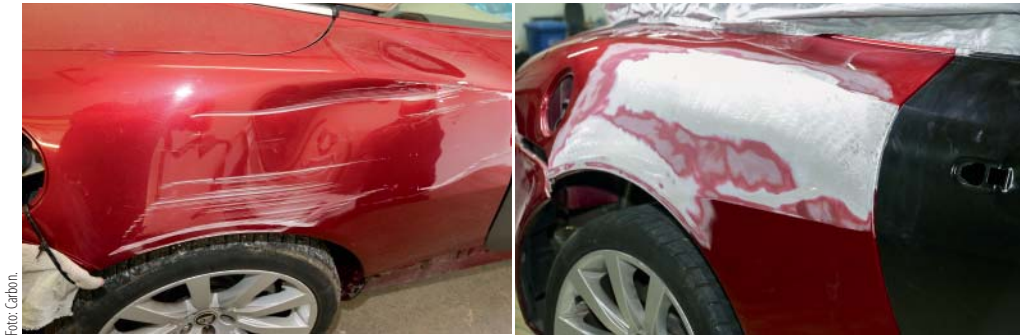
Bei Aluminium-Karosserien wie diesem Jaguar Cabrio wirken sich die Vorteile einer Instandsetzung im Vergleich zum Neuteil noch deutlicher aus als bei Stahlblechen.
